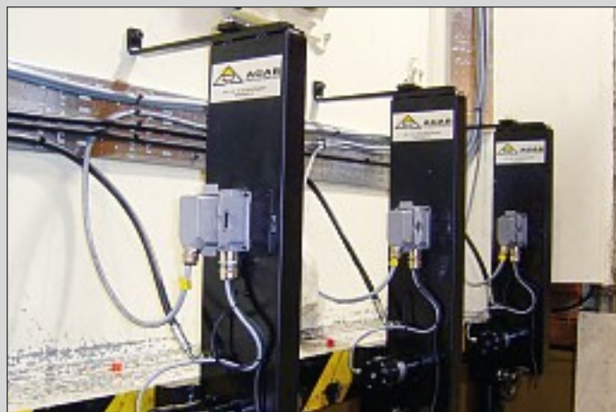
Harting kontakter för elektriska snittställen Harting plug for electrical interfaces Harting Modul für elektr. Schnittstellen
