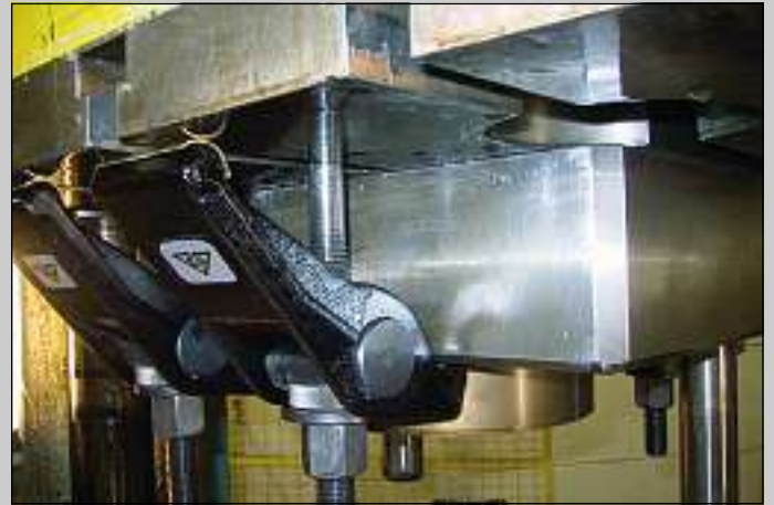
Fastspänning av ovanverktyget Clamping of upper die part Werkzeugfestspannung des oberen Werkzeuges
